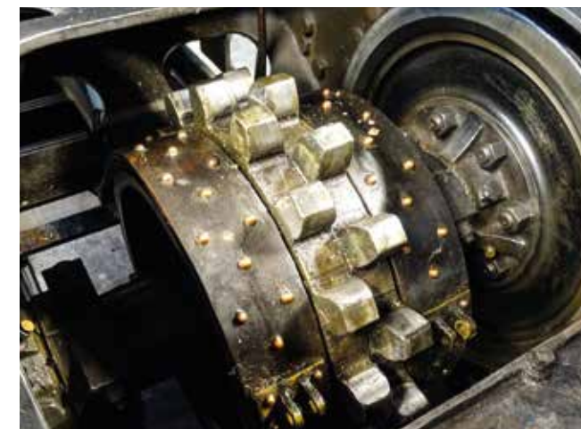
Pour changer les ressorts dans les roues dentées, les essieux sont détachés du châssis.
