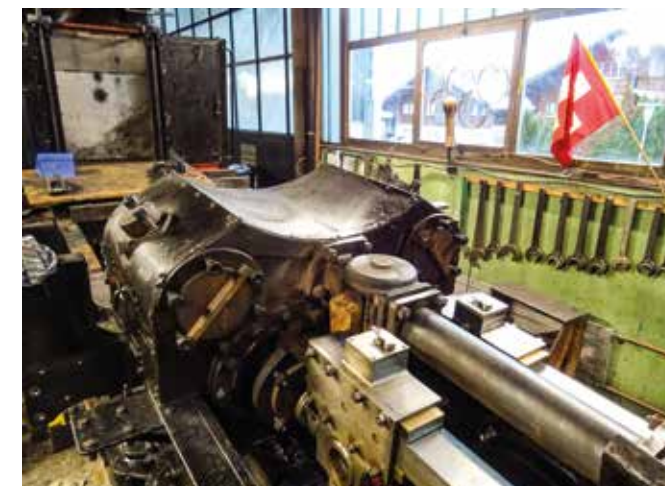
Le châssis est minutieusement nettoyé et gratté à la main afin de mettre en évidence la fatigue des matériaux et les dommages.
